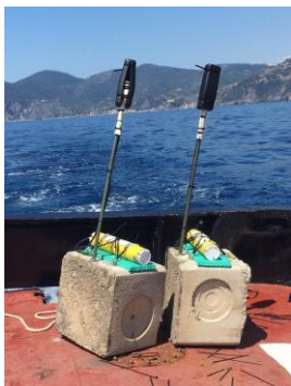
Figura 1: Sinistra: Foto del sistema: Blocco di cemento con registratore e asta metallica alla quale è fissato l'idrofono. Destra: Tabella con le posizioni definite per il monitoraggio nei 3 siti.
